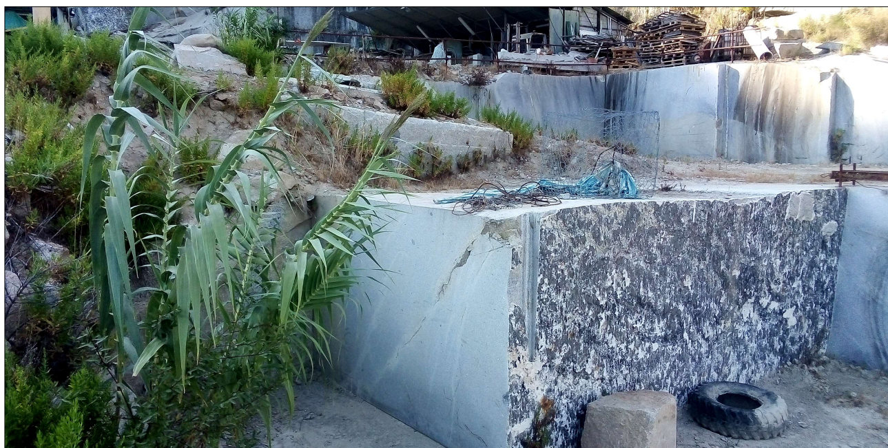
Ultimi gradoni di cava oggetto di coltivazione per raggiungimento geometrie di progetto
