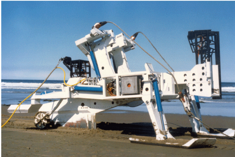
Figura 7: aratro marino, tale aratro permette la contestuale posa ed interro del cavo.
