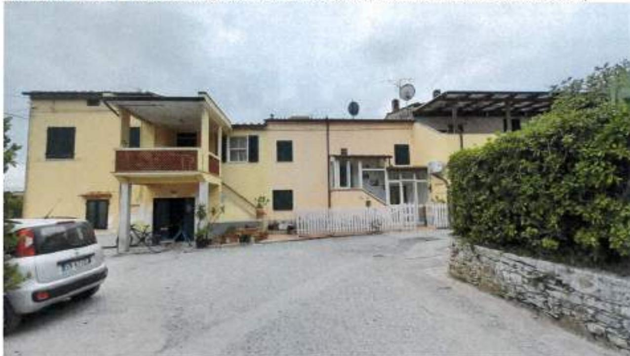
Descrizione: Prospetto lato Nord/Ovest è presente un marcapiano realizzato con varie tipologie di materiali, la copertura è realizzata a tegole portoghesied inoltre presente un pannello solare sulla copertura presenza di diverse superfetazioni su tutto il fabbricato,
