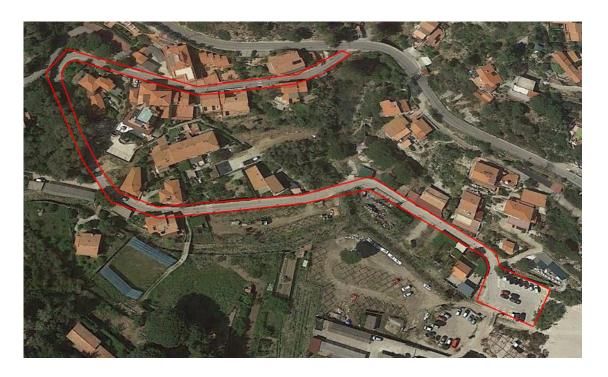
Si prevede la rimozione e sostituzione di n°16 centri illuminanti esistenti. In sostituzione, si prevede l'installazione di n°16 pali conici verniciati di altezza 5m fuori terra con corpo illuminante tipo Neri Lyra installato tramite apposito raccordo di riduzione; Nel parcheggio al termine della via si prevede inoltre l'installazione di un centro illuminante aggiuntivo.
