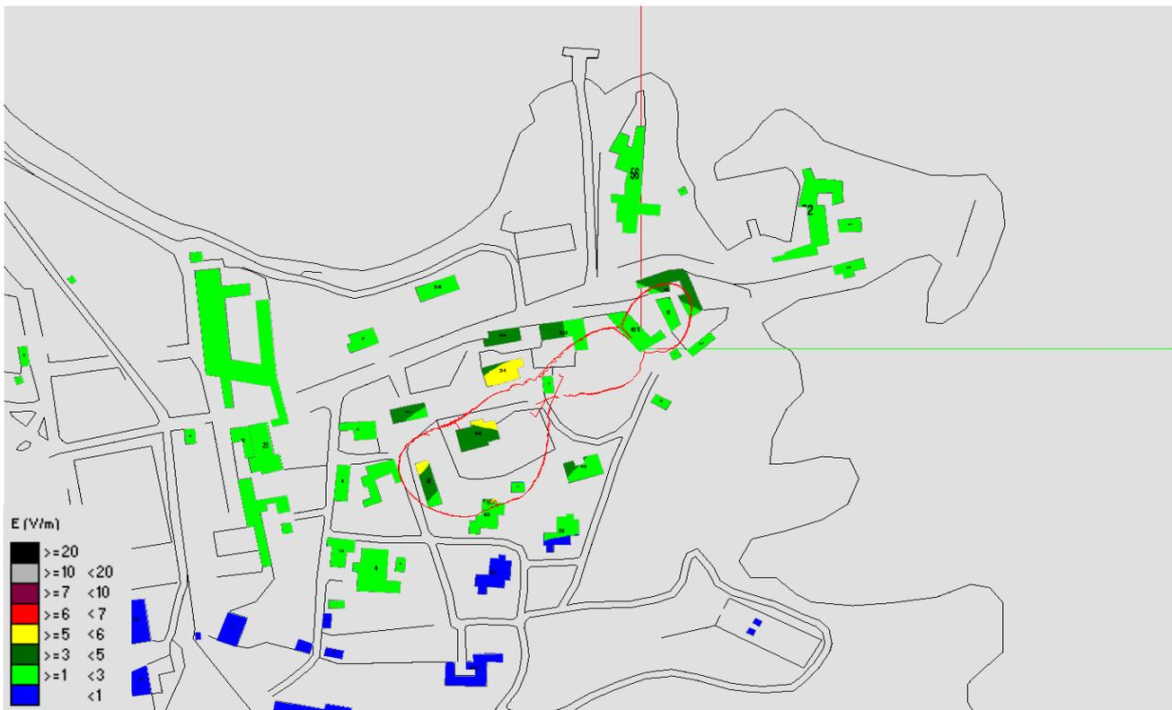
Fig. 48 Impatto Elettromagnetico – zona Pianosa – Vista dall'alto senza solido
