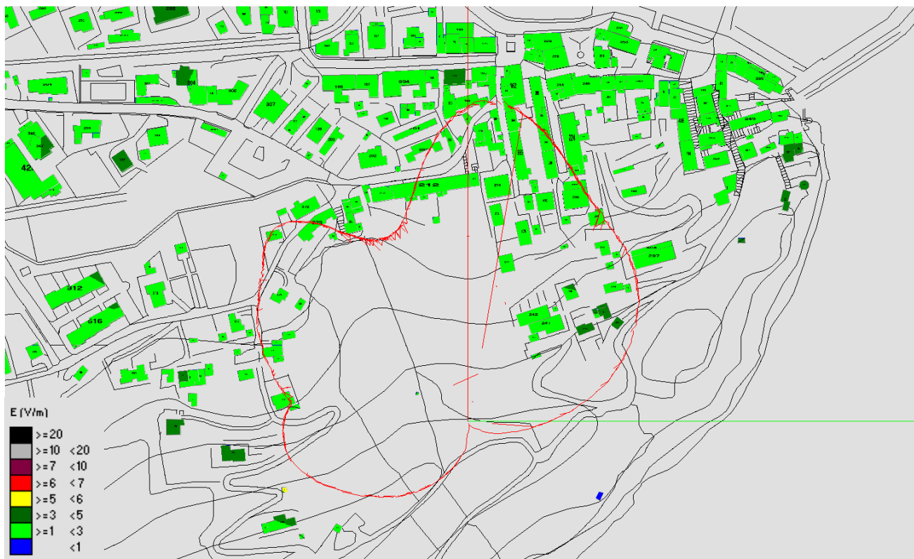
Fig. 18 Impatto Elettromagnetico – zona Serbatoio comunale – Vista dall'alto senza solido
