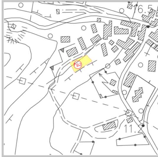
Fg2 - Fattibilità con normali vincoli - Per gli interventi edilizi diretti, i piani attuativi e la realizzazione di nuova viabilità sono da prevedere specifiche indagini geologiche e geotecniche che vadano a definire le caratteristiche dei terreni attraversati.
