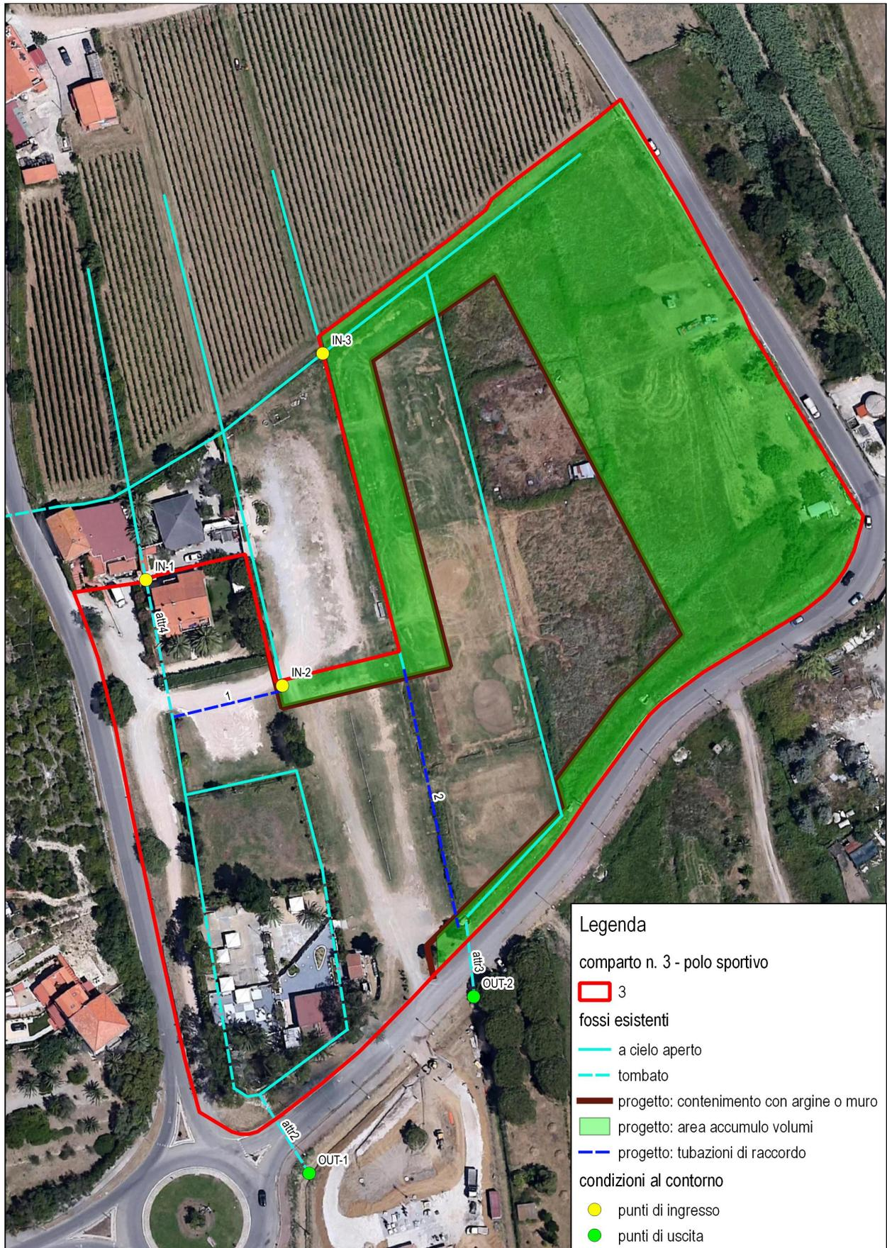
Fig. 7 – Schema progettuale per completa messa in sicurezza comparto 3
