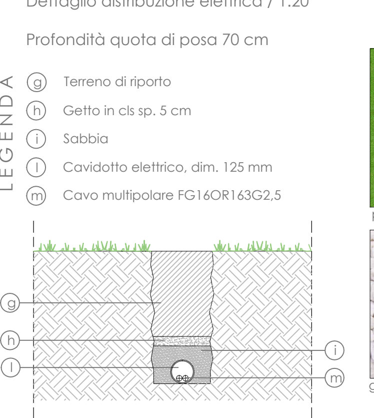
Dettaglio distribuzione elettrica / 1:20
