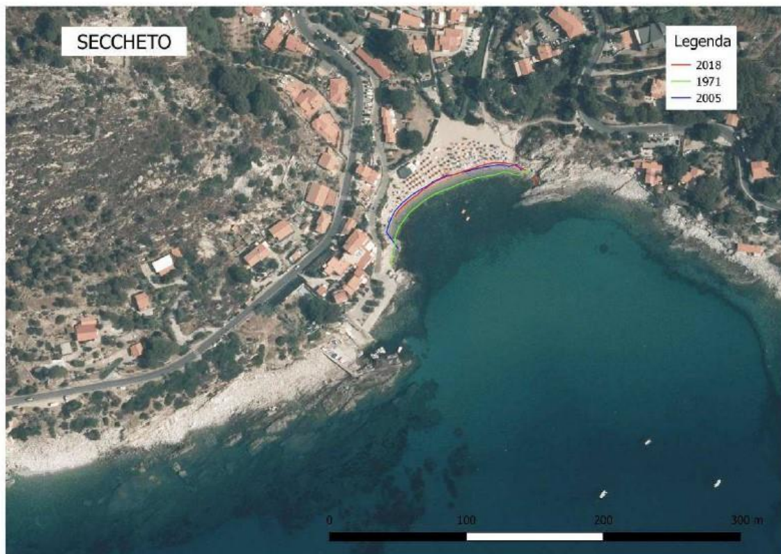
Figura 4.2 – Estratto quadro conoscitivo Regione Toscana con arretramento linea di riva dal 1971 al 2018
