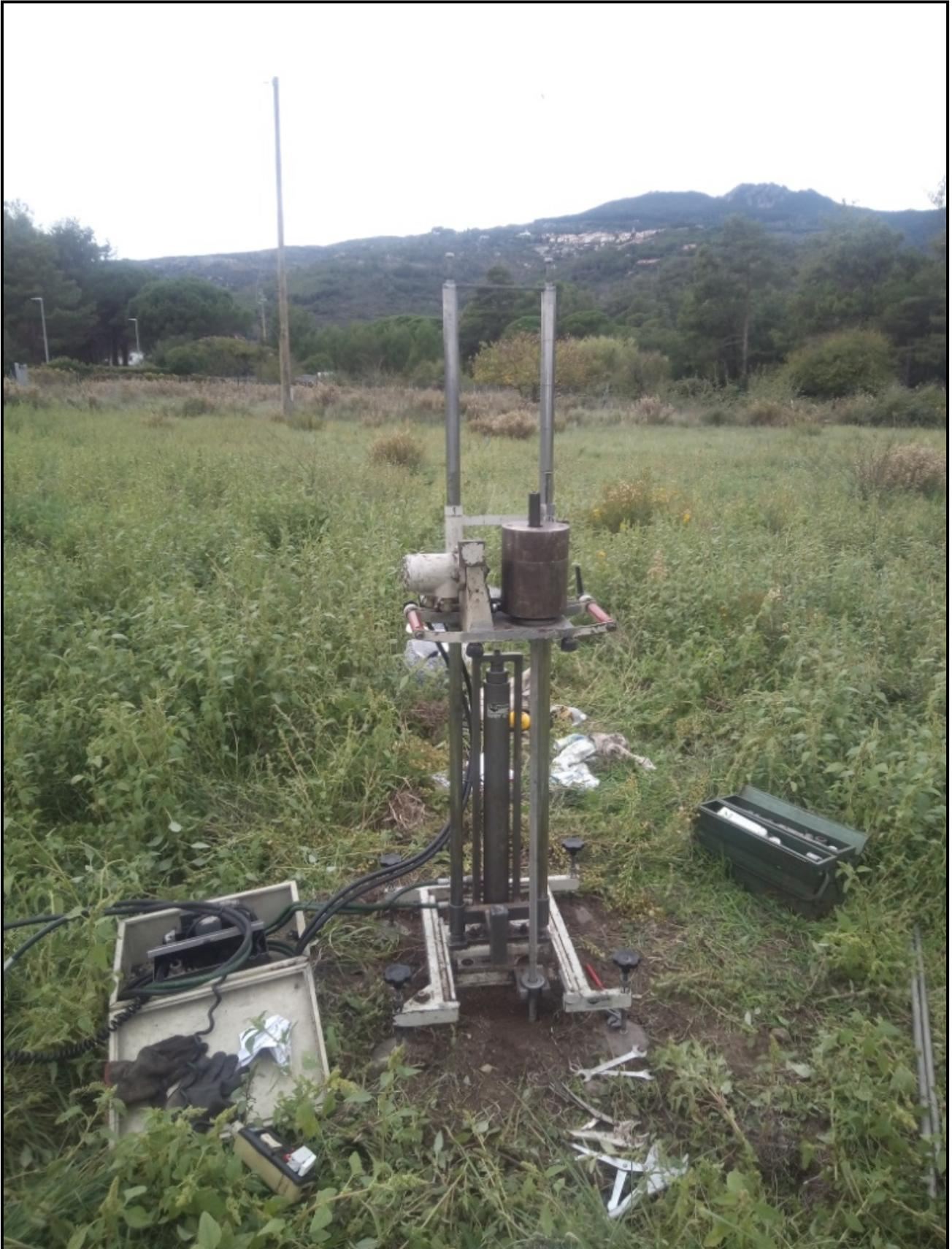
**Foto 3: prova penetrometrica P3**
