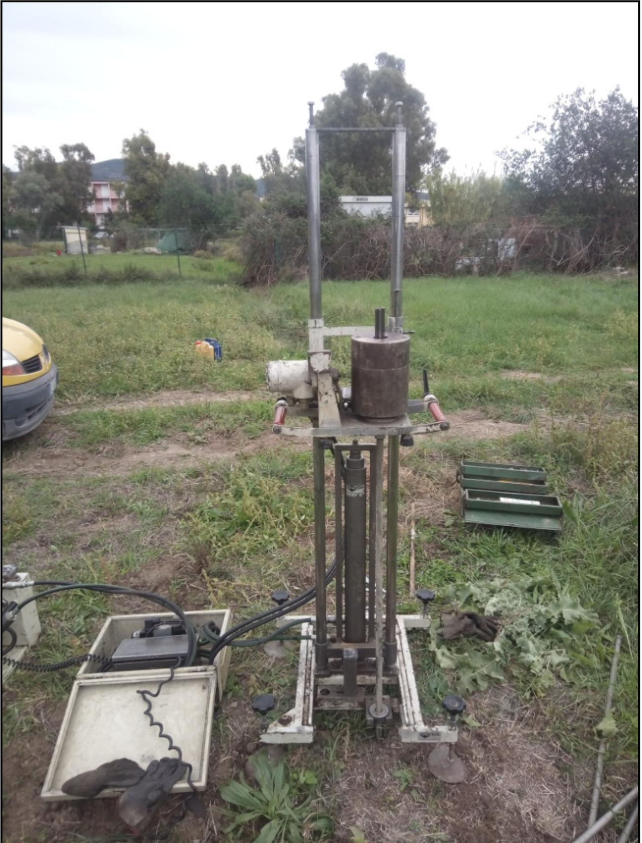
**Foto 4: prova penetrometrica P4**
