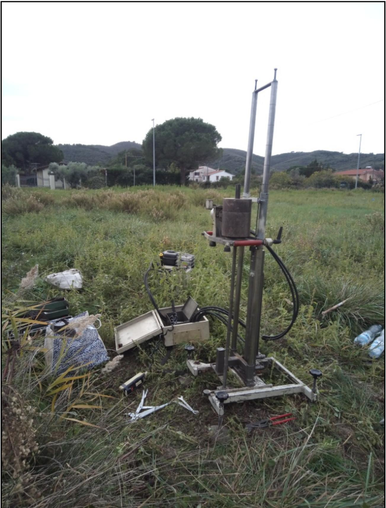
**Foto 1: prova penetrometrica P1**
