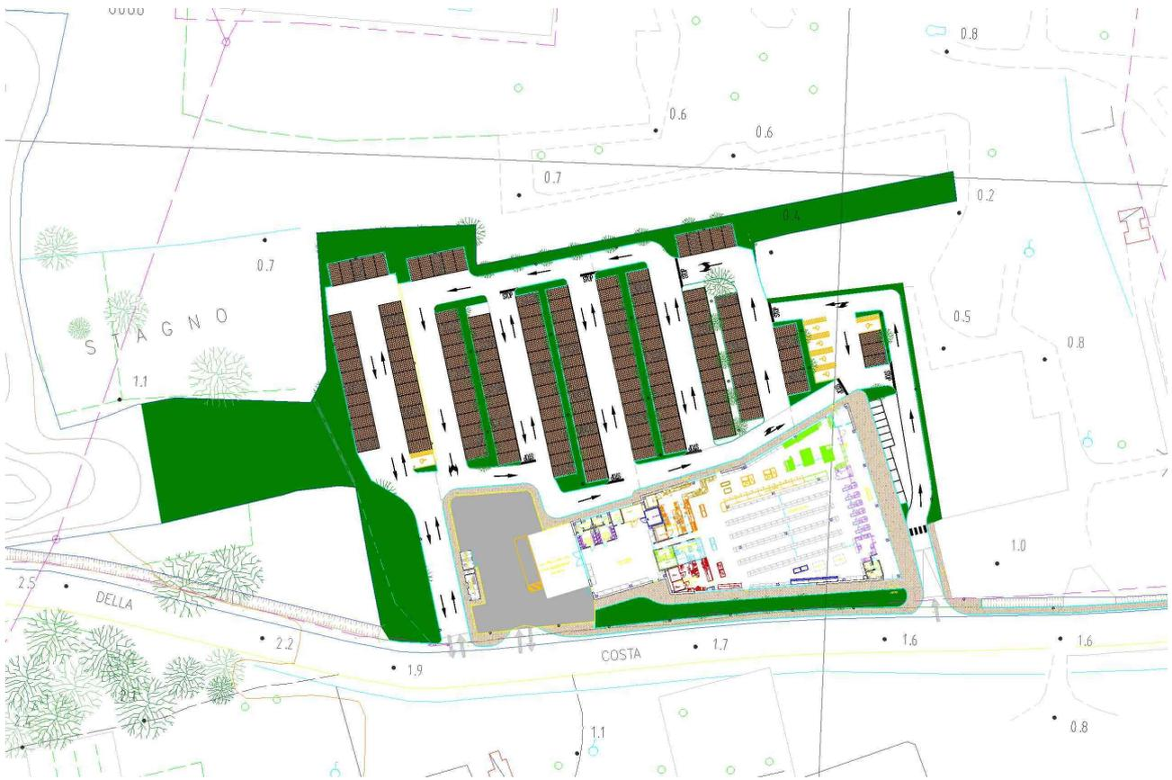
Ad ovest del centro abitato di Marina di Campo, in località denominata Stagno viene eseguito un intervento di realizzazione di un edificio commerciale composto da due blocchi, uno di altezza circa metri 6 ( zona vendita) ed uno di altezza metri 4 (zona magazzino),
