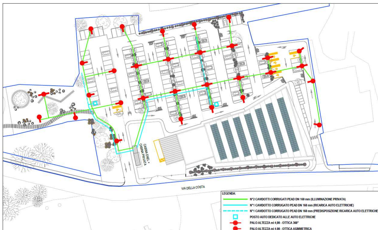
Figura 3 – Stralcio della planimetria dell'impianto di illuminazione
